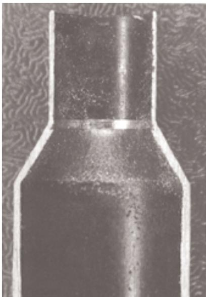
Bilde viser en 6mm PPC hylse som er frest med verktøy fra "K&M Service".
