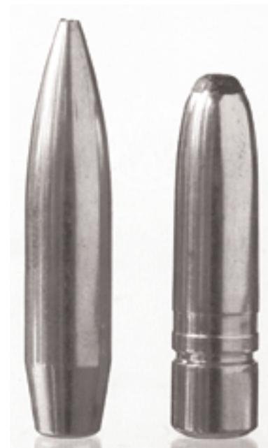
Den ballistiska koefficienten har stor stor inverkan på vindavdriften. Ju högre koefficient desto mindre vindavdrift. Den spetsiga kulan är en 7 mm Sierra 168 grains Matchking vars ballistiska koefficient är hela 0,62. Den trubbiga jaktkulan är en 11 grams (170 grains) Lapua Mega med den mer rimliga koefficienten 0,319.
